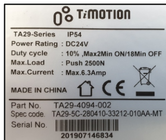
Typenschild auf dem Aktuator aufgebracht
