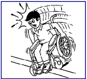
FAHREN SIE STUFEN ETC: NIE NUR MIT EINEM RAD HINAB. BEACHTEN SIE DIE MAXIMALE STEIGHÖHE!
