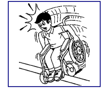
FAHREN SIE STUFEN ETC: NIE NUR MIT EINEM RAD HINAB. BEACHTEN SIE DIE MAXIMALE STEIGHÖHE!
